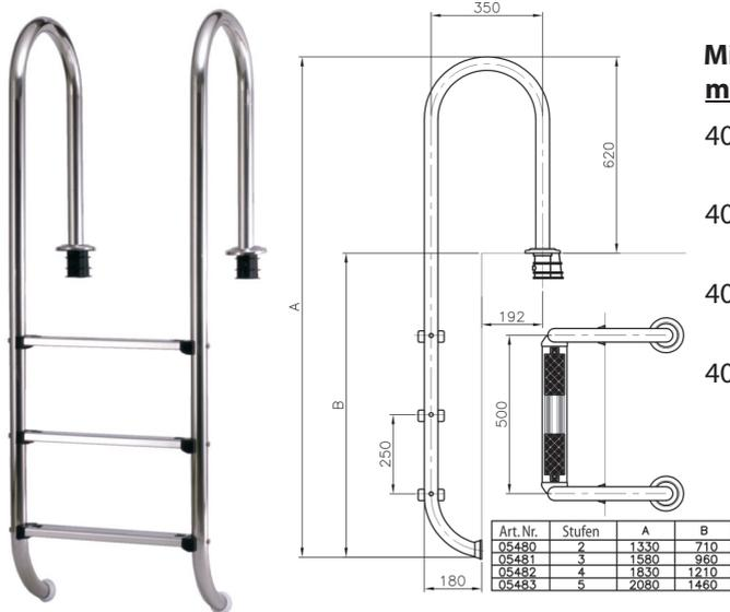
**Mit Ankersockel - enger Holm D 43 mit rutschsicheren Auftrittsstufen**
