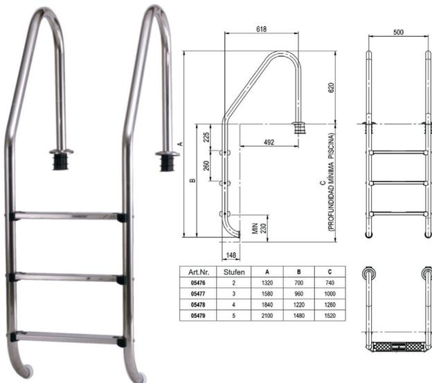
**Mit Ankersockel - breiter Holm D 43 mm mit rutschsicheren Auftrittsstufen**
