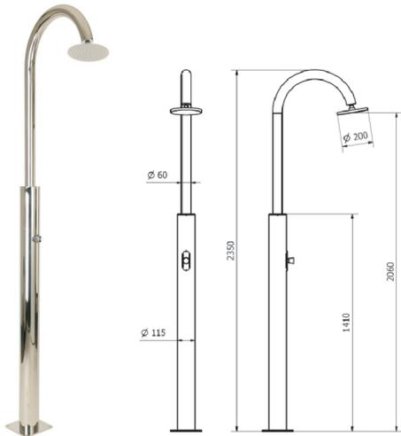
38928 **Kalt-Standbrause "ROMEO EXCLUSIV", V4A-SV** mit Selbstschlussventil fix eingestellt auf 15 sek., Anschluss von unten flexibel 1/2" I.G., schöner Regenwaldduschkopf D 200 mm, V4A-Standrohr D 115/60 mm hochglanz poliert
